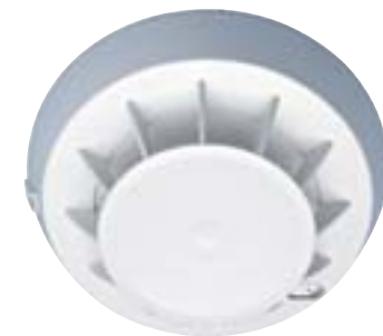
HI322: Wärmedifferenzialmelder Klasse 2. Misst kontinuierlich die Umgebungstemperatur und gibt Alarm, falls Höchstwerte dauerhaft überschritten werden. Ideal für Küchen.
