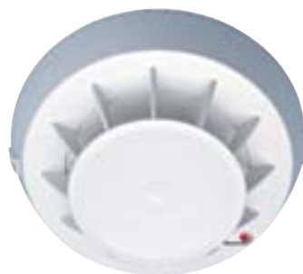
HI320: Wärmedifferenzialmelder. Für Brandsituationen, in denen eine rasche Temperaturerhöhung zu erwarten ist. Auch für staubige und feuchte Umgebungen geeignet, z.B. Sägemühlen oder Bäder.
