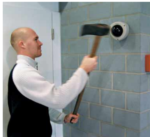
1000 kg Schlagwiderstand und Schutzart IP66
