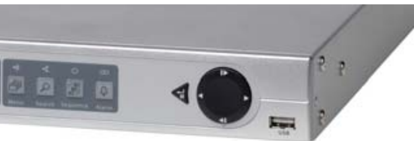
In die Frontplatte integrierte Telemetrikontrolle für Schwenk-/Neige-Zoom und Voreinstellungen.
